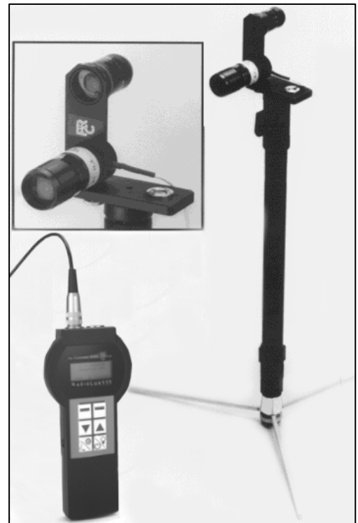
Bild 5: Leuchtdichtemessung mit Leuchtdichte-Vorsatz und Visiereinrichtung
