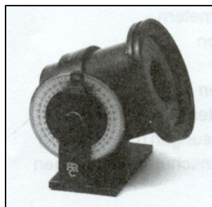
Bild 7: Tubus mit Irisblende zur Ausblendung von Streulicht
